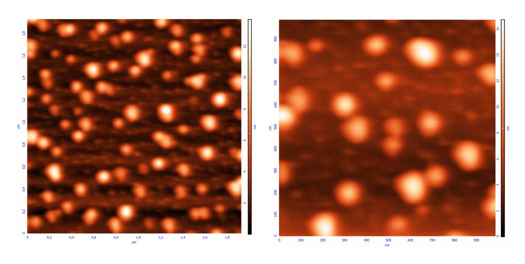
Плотность и средние геометрические размеры полученных наночастиц никеля. Первое значение соответствует контрольному образцу, второе – намагниченному (нормально поверхности)
